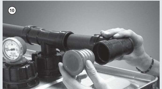
Nur bei einreihiger Aufstellung! Winkel-Sammelrohr und Anschlagdichtung für Entlüftungsanschluss montieren. Die einreihige Tankanlage ist nun fertig montiert. Only with single-row installation! Install angled manifold and compression seal for ventilation connection. The single-row tank system is now completely installed. Uniquement pour une installation en une série ! Monter le tube collecteur coudé et le joint à butée pour le raccord de purge. Le montage de l'installation de réservoirs en une série est maintenant terminé. Alleen bij opstelling in één rij! Hoek-verzamelbuis en aanslagpakking voor ontluchtingsaansluiting monteren. De montage van de enkelrij tankopstelling is nu klaar.
