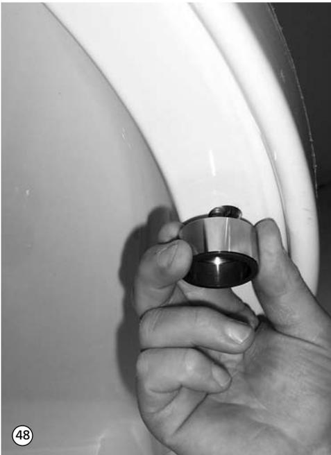
48. Lagerschale oben abschrauben. Lagerschale, Werkzeug und Befestigungsmaterial auf dem Dach ablegen.
