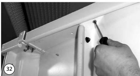
32. Dach mit Paneelwänden verschrauben (4/5 Stück M6x20).
