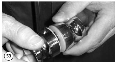
54. Magnetdichtung auf Seitenteil aufstecken (Dichtung hat keine Gehrungsschnitte).
