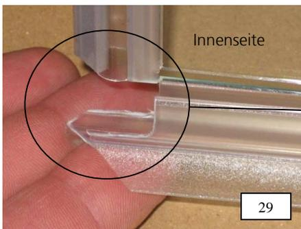
29. Wannendichtung ausklinken, und am Türflügel montieren. Die Länge wird bündig mit der Scheibenhinterkante zugeschnitten.
