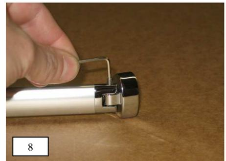
9. Den Gelenkkopf durch Herausdrehen der Schraube 3,5 x 32 mm demontieren.
