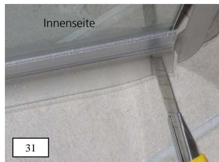
32. Es wird nur der flexible Abweiser ausgeklinkt.
