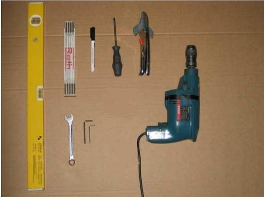
Schlagbohrmaschine mit Steinbohrer
