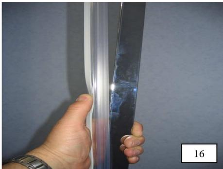
16. Türmagnetdichtung oben auf das 6 mm U- Profil einige Zentimeter aufstecken, somit wird ein abknicken verhindert. Schrägstehender Magnetstreifen muss zur Außenseite zeigen. Die Türmagnetdichtung wird unten am Profil bündig montiert und auf der gesamten Länge auf das Profil aufgedrückt. Oben muss sie an der Profiloberkante abgeschnitten werden.
