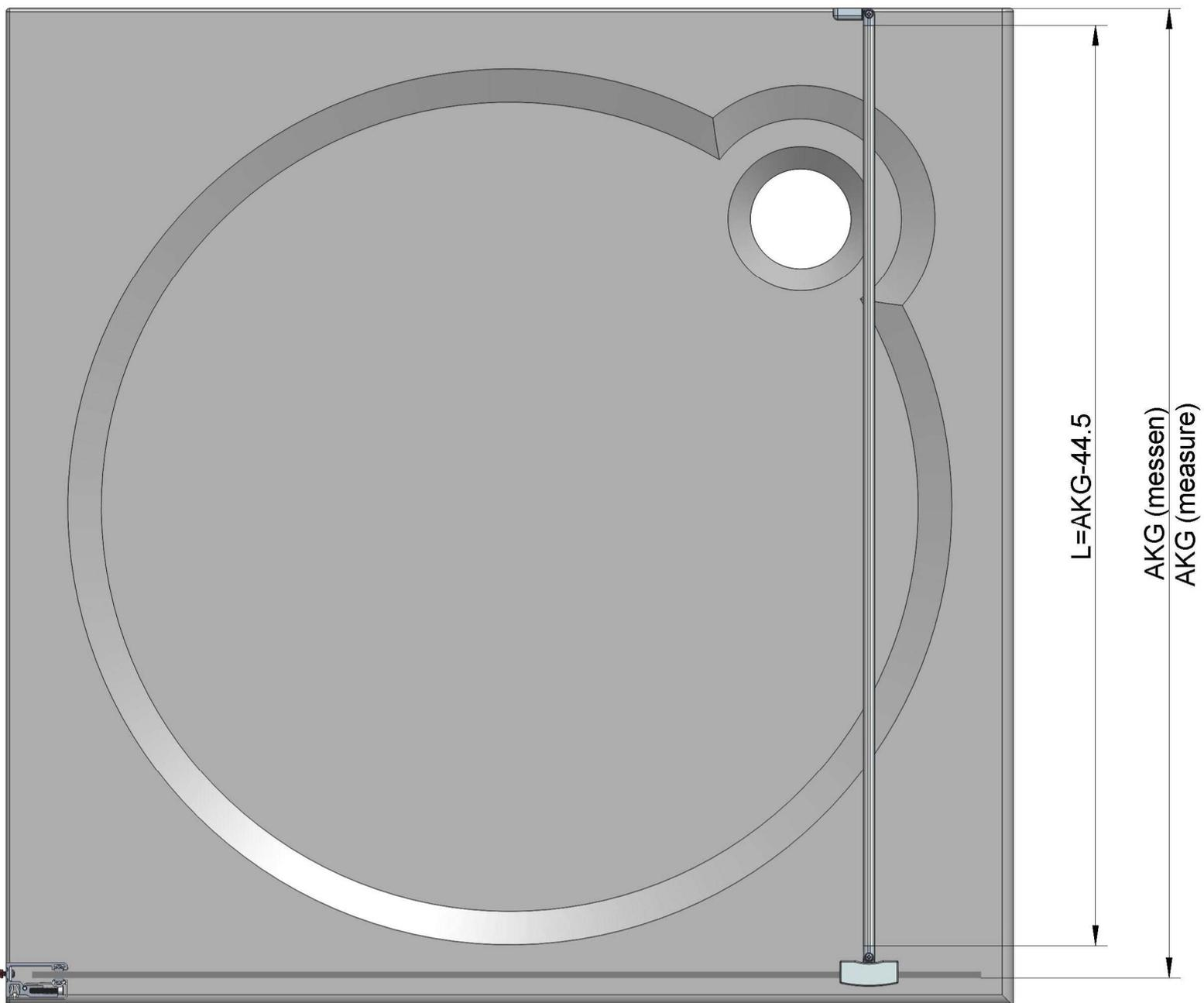
Halterrohr ausrichten, Bohrungen
