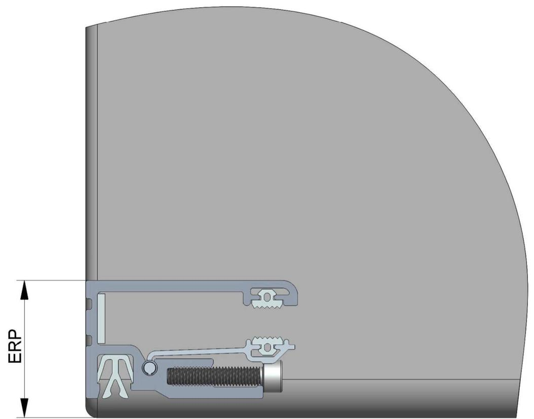
PVC Streifen unterlegen, Scheibe einsetzen
