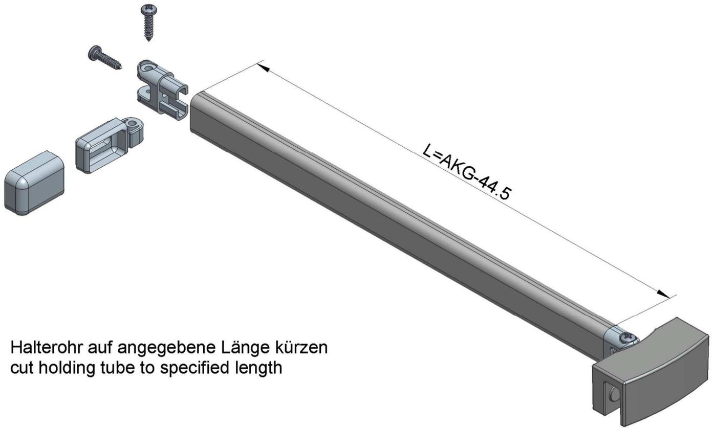
Halterohr auf angegebene Länge kürzen
