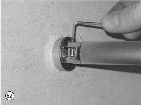
62. Das Halterrohr zurückschwenken und Verbindung zur Gelenkplatte durch Eindrehen des Gewindestiftes M4 herstellen.
