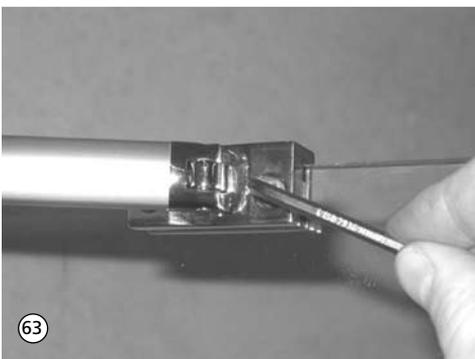
63. Ausrichtung der Scheibe kontrollieren. Gegebenenfalls Scheibenhalter am vorderen Gewindestift lösen, Scheibe neu ausrichten und Scheibenhalter mit dem vorderen Gewindestift erneut fixieren.
