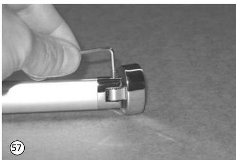
57. Gelenkkopf und -platte in umgekehrter Reihenfolge am gekürzten Halterohr montieren.
