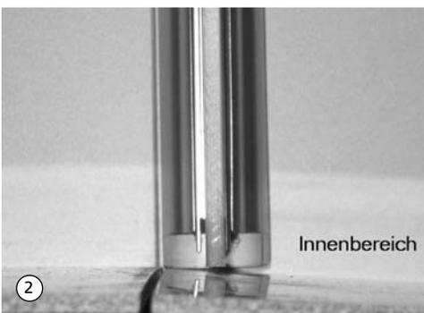
2. Bei Montage auf Fliesenboden ist darauf zu achten, dass die Gelenkeinheit und das U-Profil in den Innenbereich des Gefälles montiert werden. Vorteil ist, dass austretendes Wasser sofort in den Innenbereich zurücklaufen kann.
