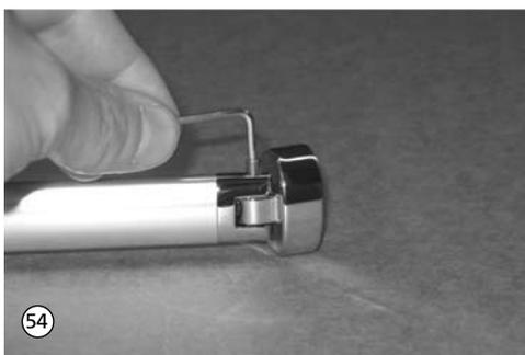
54. Gewindestift M4 x 16 mit Innensechskantschlüssel SW 2 herausdrehen, bis Gelenkplatte zu entnehmen ist.
