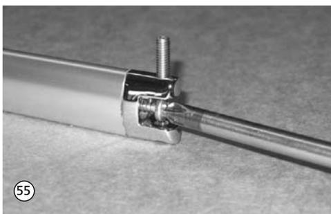
55. Den Gelenkkopf durch Herausdrehen der Schraube 3,5 x 32 demontieren.
