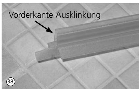
38. Darstellung der anschlagseitigen Wannendichtung mit Ausklindung für den Anschluss an die Spaltdichtung.
