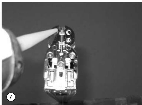
7. Die äußere Hälfte der unteren Gelenkplatte dünn mit Silikon bedecken und darauf achten, dass der mittige Kanal nicht mit Silikon verschlossen wird.
