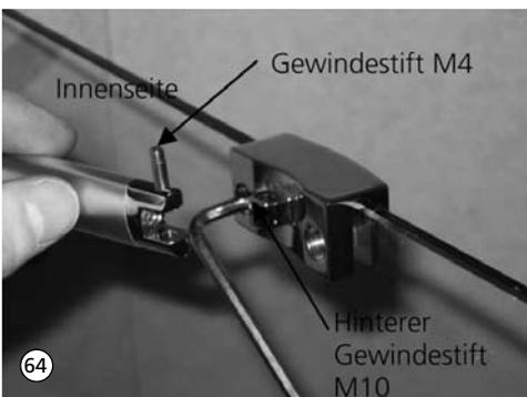
64. Seitenwand und Türen so zueinander ausrichten, dass die Türen exakt schließen und parallel zur Fuge oder Wanne verlaufen, danach Scheibenhalter mit dem vorderen Gewindestift M10 erneut an der Seitenwand fixieren. Bei korrekter Position das Halterrohr vom Scheibenhalter mit Gewindestift M4 lösen (siehe Pfeil) und den hinteren Gewindestift M10 ebenfalls fixieren. Anschließend das Halterrohr wieder mit Scheibenhalter verbinden.
